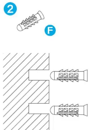
2. Stecken Sie die vier Dübel F in die Bohrlöcher.
