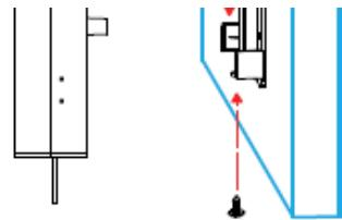
4. Platzieren Sie den NR730x so, dass die Gerätehalterung mit der Wandhalterung übereinstimmt, und schieben Sie ihn vorsichtig nach unten. Befestigen Sie die Gerätehalterung mit der M3-Blechschaube J durch das untere Loch an der Wandhalterung.
