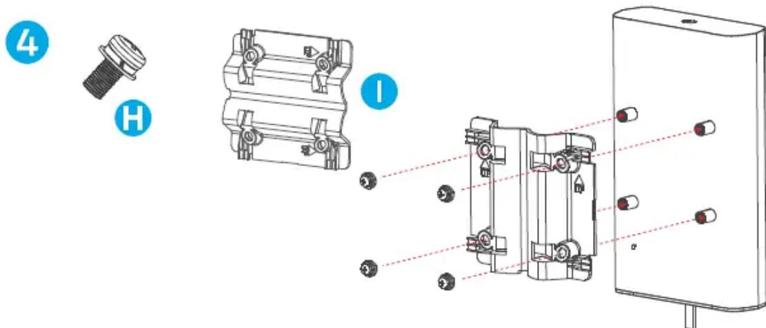
3. Befestigen Sie die Gerätehalterung I mit den M4 Rundkopfschrauben H, Federn und Unterlegscheiben an der Rückseite des NR730x.
